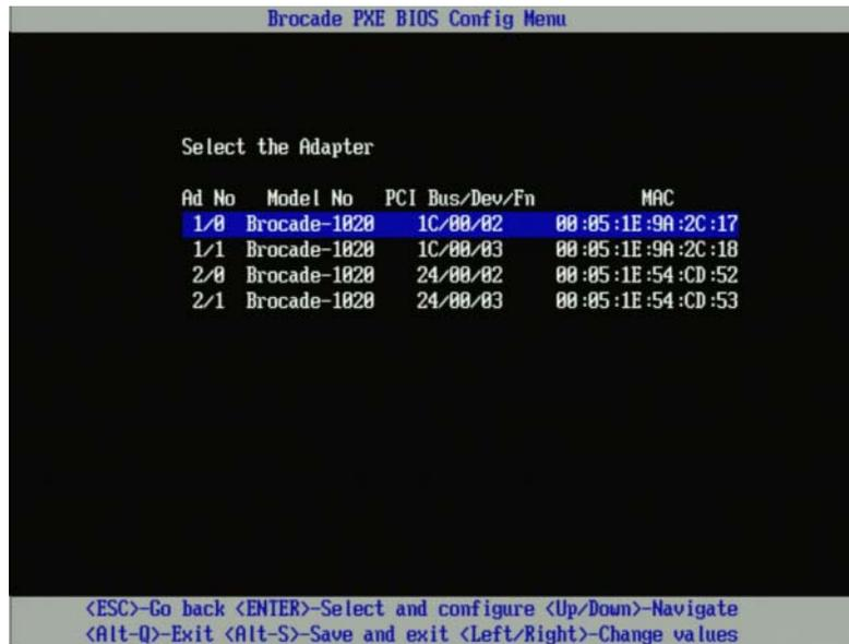
Sous la colonne Ad No (Numéro d'adaptateur), 1/0 et 1/1 sont respectivement le premier port et le deuxième port sur le premier adaptateur installé tandis que 2/0 et 2/1 sont le premier et le deuxième port du second adaptateur installé.
